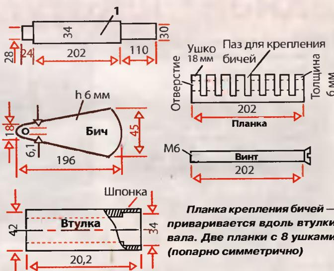
Рис. 2 Детали рабочего узла
