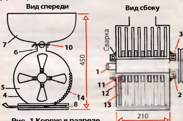
Рис. 1 Корпус в разрезе
